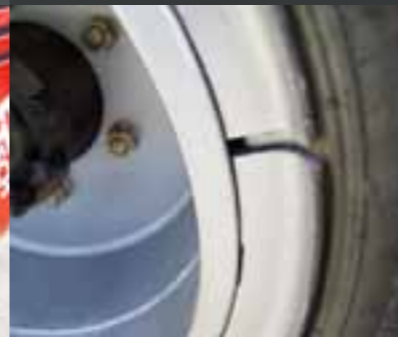
Felgenreifen für Reifenwechsel ohne Montiergerät
